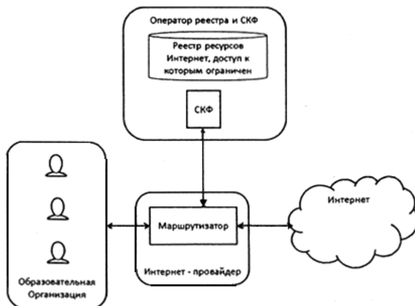
Рис.5. Схема работы контент-фильтрации при едином решении
